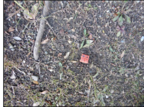
⑩ 境界標識:プラスチック杭
