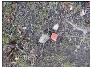
⑭ 境界標識:プラスチック杭
