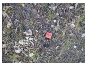
⑬ 境界標識: プラスチック杭
