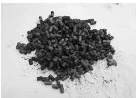
▲下水道管に詰まっていたペット用トイレの砂
