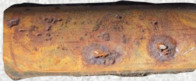
埋設されていた老朽管
